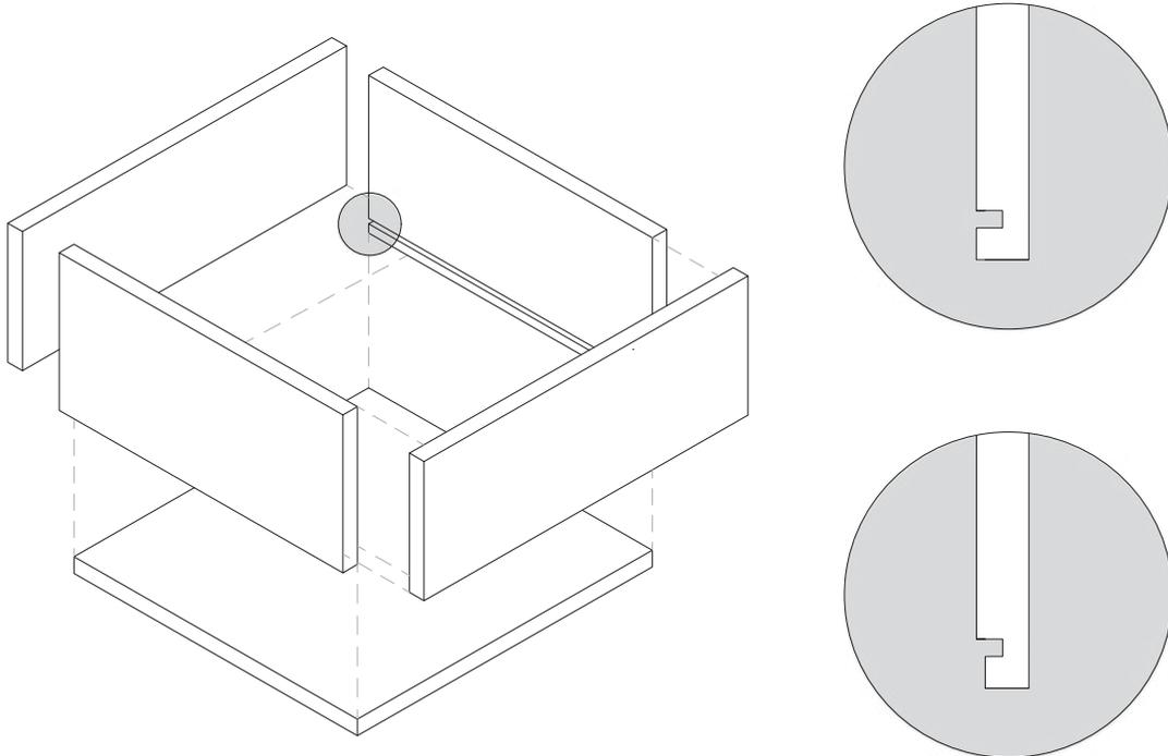
Para la colocación de las guías, según cual se utilice, se deberá realizar un ranurado en los laterales del cajón para su encastre junto al fondo.
